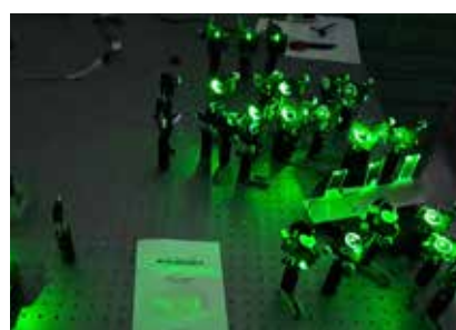
Установка для измерения позиции объекта, которая использует только оптическую когерентность
