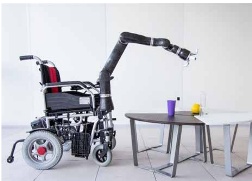
Комплекс «Робоком» для ассистивной помощи людям с сильным ограничением двигательных способностей
