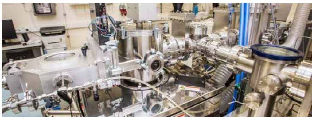
Установка для выращивания сверхтонкого оксида молибдена, необходимого для последующего синтеза двумерного дисульфида молибдена
