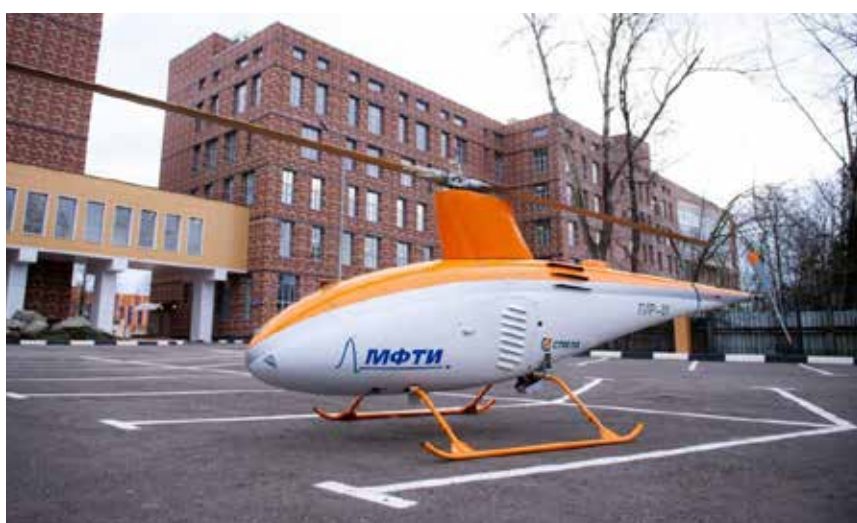
Программно-аппаратный комплекс оперативного мониторинга на базе беспилотного летательного аппарата вертолетного типа
