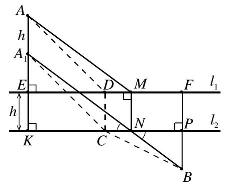
Определившись геометрически с положением моста  $MN$ , найдём расстояние  $EM$ . По построению и условию:  $A_1K = AE = 600$  м,  $EM = KN$ ,  $KN + NP = EF = 1200$  м,  $BP = 300$  м.  $\triangle A_1KN$  подобен  $\triangle BPN$  (по двум углам:  $\angle A_1KN = \angle BPN = 90^\circ$ ,  $\angle A_1NK = \angle BNP$  – как вертикальные). С помощью свойств подобия и используя данные построения и условия, находим:
