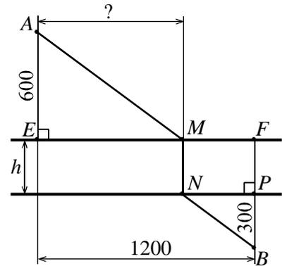
**Решение.** Берега канала – параллельные прямые  $l_1$  и  $l_2$  (см. рисунок). Проведём  $AK \perp l_2$  и на прямой  $AK$  отложим отрезок  $AA_1 = h$ . Соединим точки  $A_1$  и  $B$ ; отрезок  $A_1B$  пересечёт прямую  $l_2$  в точке  $N$ . Точка  $N$  определяет положение моста  $MN$ .
