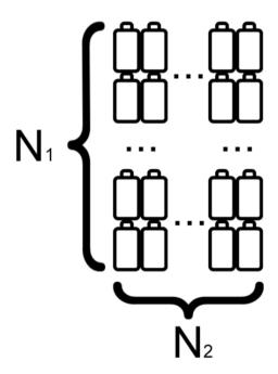
Т.к. внутри «блока» батарейки соединены последовательно, то  $N_1$ \* 1,25 B >= 10 B,  $N_1$  >= 8.
